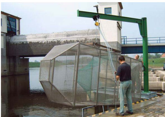
oben: Spezialreuse zur Quantifizierung der Wanderung junger Aale beim Einsatz in der unteren Havel
