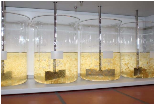
Fäll-/Flockungs- und Sedimentationsversuche im IfB-Labor
