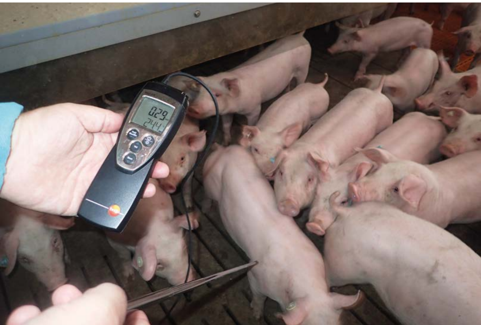
Abb. 50: Mit einem Hitzdrahtanemometer sind auch geringe Luftgeschwindigkeiten messbar
