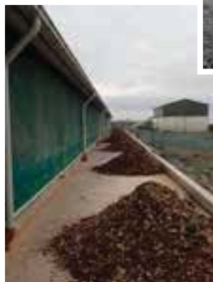
Rindenmulch oder Sand im Nahbereich kann maschinell bearbeitet werden, sodass keine Pfützen entstehen; der Belag ist zudem leicht austauschbar
