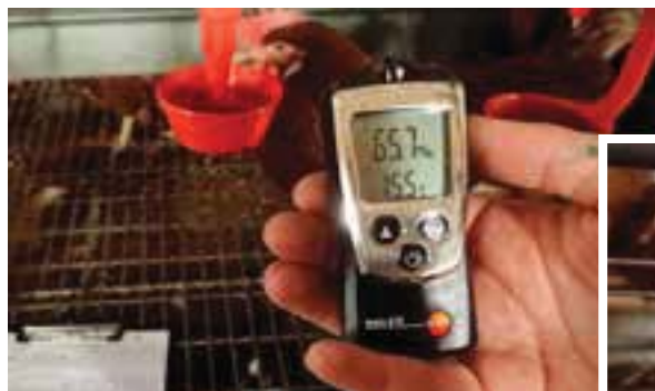
Thermo-Hygrometer zum Messen von Temperatur und Luftfeuchtigkeit
