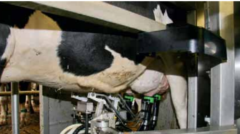
Der Roboterarm setzt die Melkbecher an. Foto: Bauernzeitung
