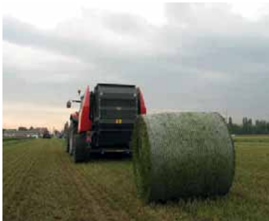
Das Pressen erfolgt in Rundballen, wenn das Futter noch 20 bis 30 Prozent Feuchtigkeit aufweist. Foto: Fritz Fleege
