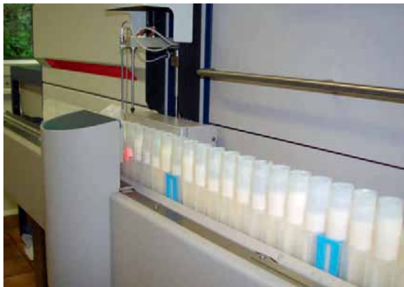
Automatische Messung der Milchproben am Untersuchungsgerät (Combi Foss). Foto: Bauernzeitung
