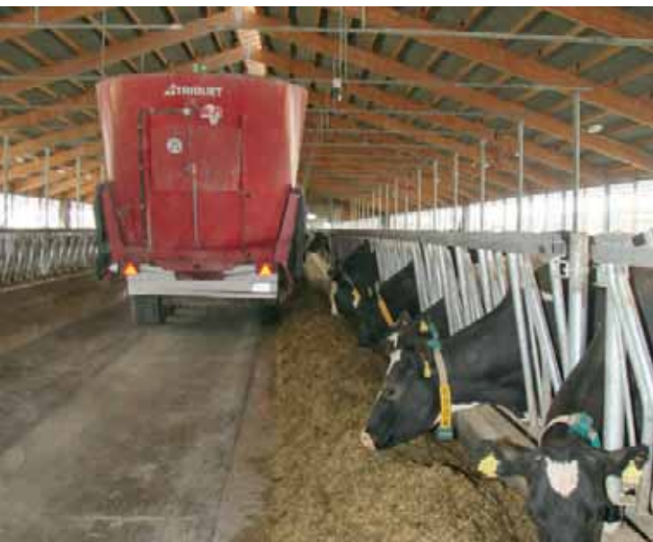
Der Futtermischwagen fasst 46 Kubikmeter. Mit einer Ladung lassen sich 400 Kühe versorgen. Foto: Fritz Fleege
