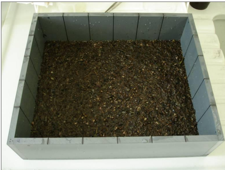
Abbildung 5: Unterprobensieb mit homogenisierter Probe
